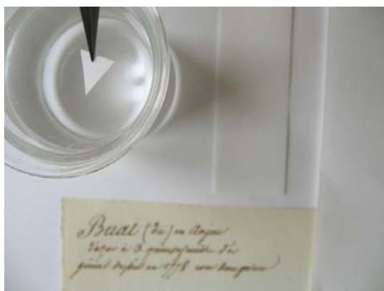
Figure 5 : immersion du papier test
